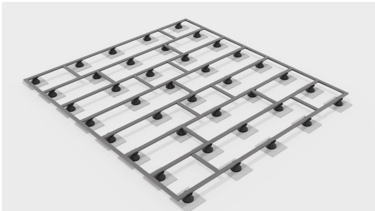
Příklad ztužené podkladní konstrukce
